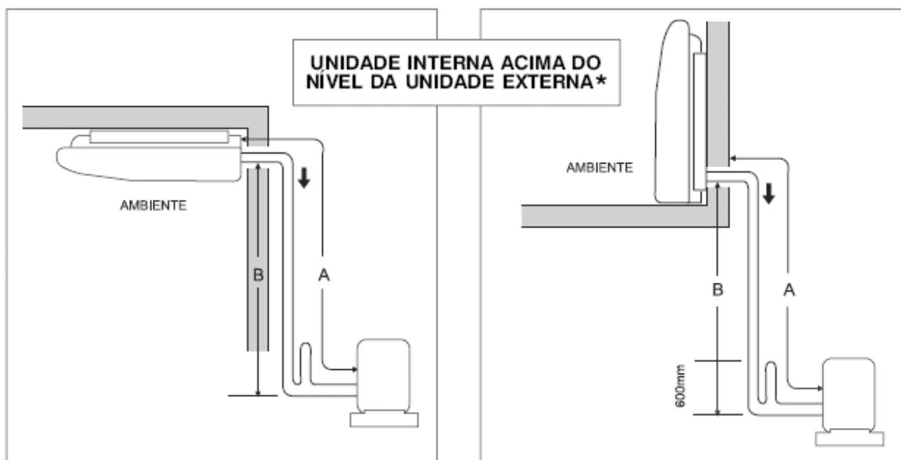
\* NESTA SITUAÇÃO, RECOMENDA-SE A INSTALAÇÃO DE UM SIFÃO NA LINHA DE SUÇÃO PARA PROTEÇÃO DO COMPRESSOR, AMENIZANDO EVENTUAIS GOLPES DE FLUÍDO REFRIGERANTE EM FORMA LÍQUIDA.
